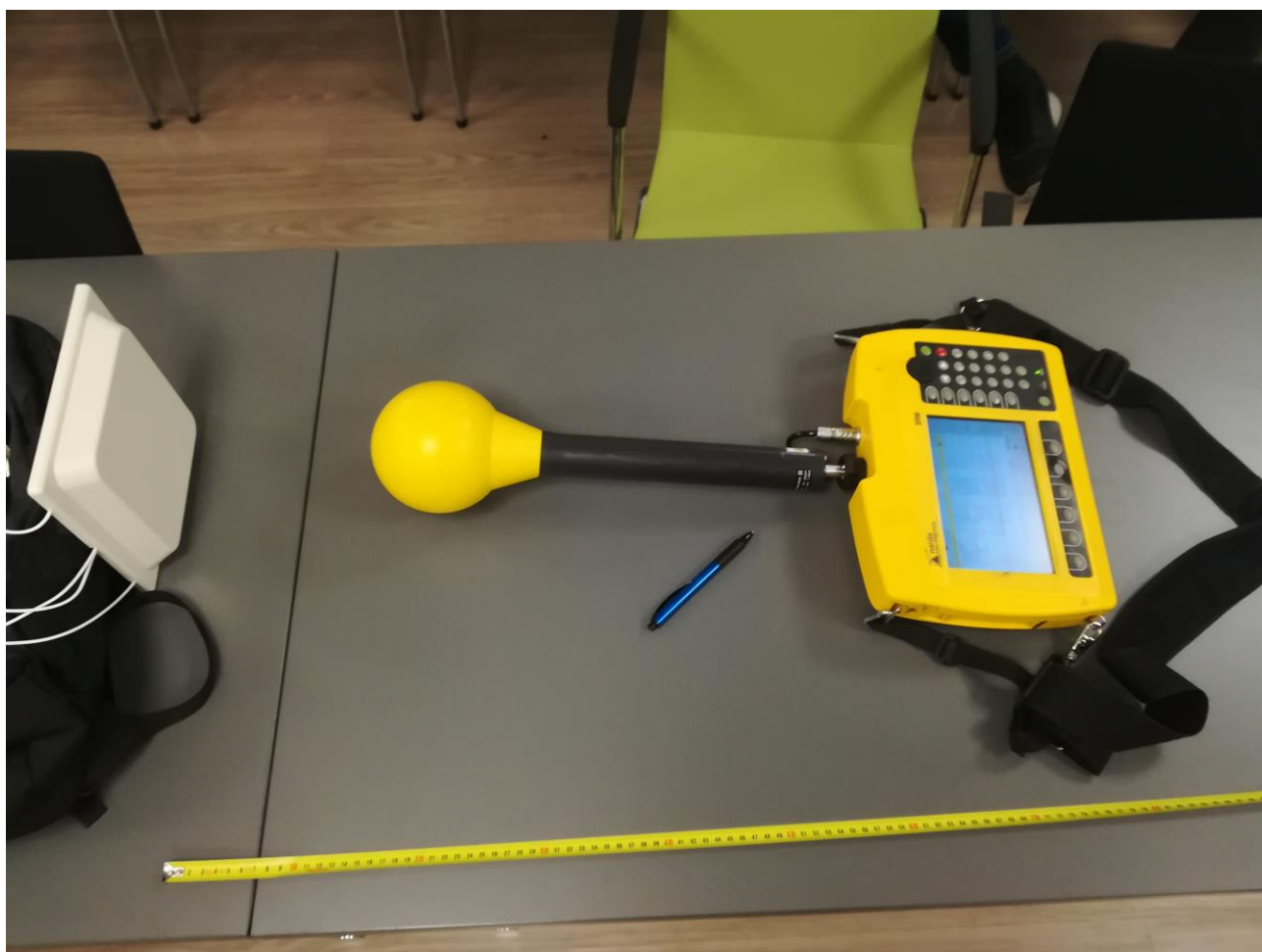
S 2: Meritve WiFi dostopne točke Fortinet FortiAP 223E z zunanjo anteno Mars MA-WC2458.
